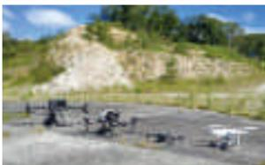
砂防施設の機能を長期にわたり持続させるには点検による健全度の診断が必要です。UAVを活用して定期点検を行うことで、危険な場所に人が直接立ち入ることなく、短時間のフライトで施設状況を把握することができ、撮影画像から作成した三次元モデルで施設の劣化状況を定量的に評価できるなど、当社でもi-Construction\*を積極的に業務へ取り入れ、既往技術の効率化・高度化を目指しています。
